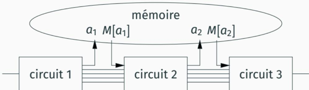
Un modèle de calcul intermédiaire entre circuits et modèle RAM.
